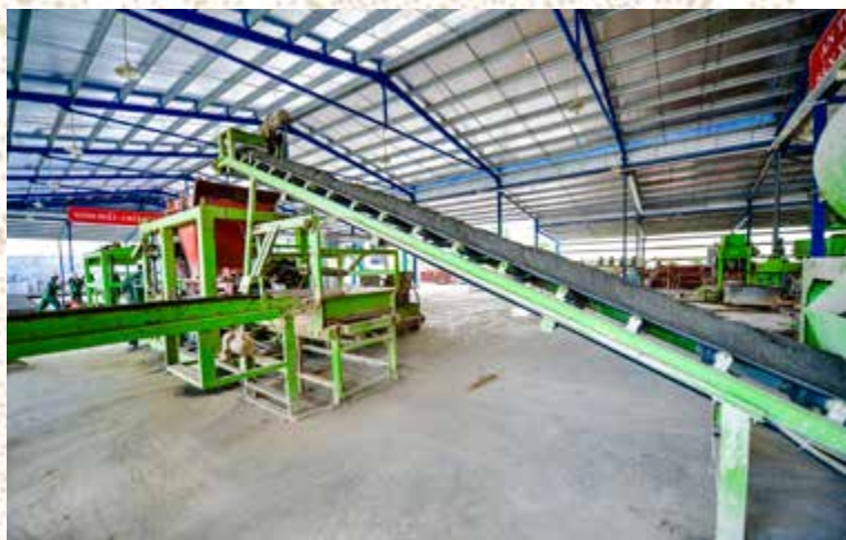
Dây chuyền tự động hóa sản xuất gạch ngói không nung.
